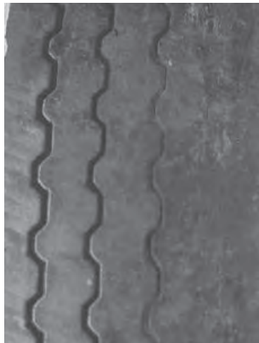
Usure irrégulière due à un mauvais alignement ou un bombement.
