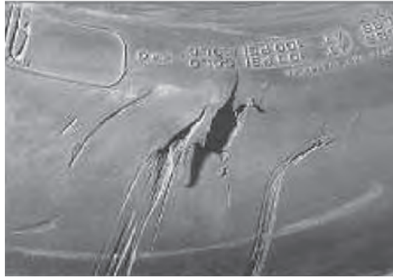
Pneu percé en profondeur au niveau de la paroi latérale.
