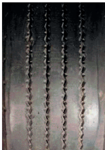
Usure rapide du bord de la bande de roulement en raison d'un sous-gonflage.
