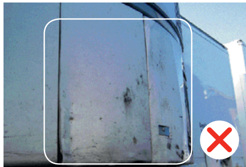
Dommages importants aux portes gênant la manipulation des portes.
