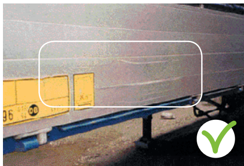
Ridelle endommagée suite à une collision, non percée et profil non déformé.
