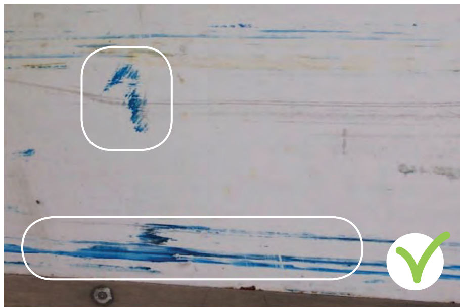
Eraflures du panneau en stratifié de fibres de verre sans perforation du Gelcoat.
