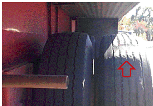
Pneus jumelés de diamètres différents ou dépareillés.
