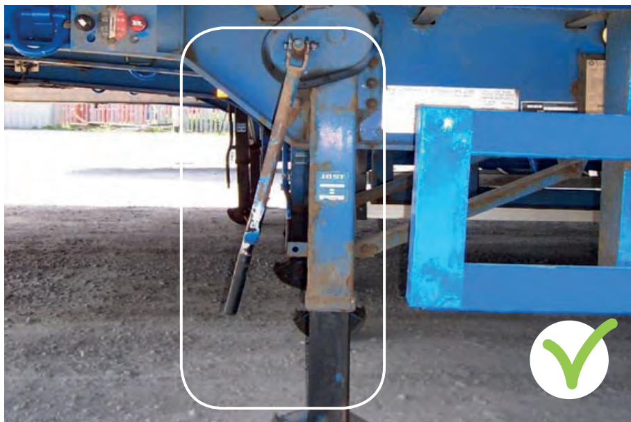
Béquille droite avec manivelle fixée.
