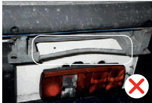
Echelle d'accès arrière restituée en mauvais état.
