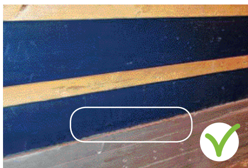
Ridelle endommagée mais non percée ; déformation acceptable puisqu'elle ne gêne pas l'utilisation de la ridelle.
