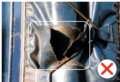
Entailles non-réparées dans le rideau au niveau des coins ou des poteaux de tension.
