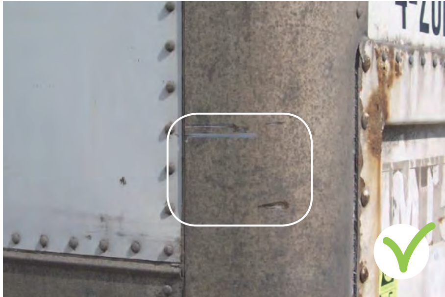
Poteau d'angle endommagé : la surface est entaillée mais pas percée.
