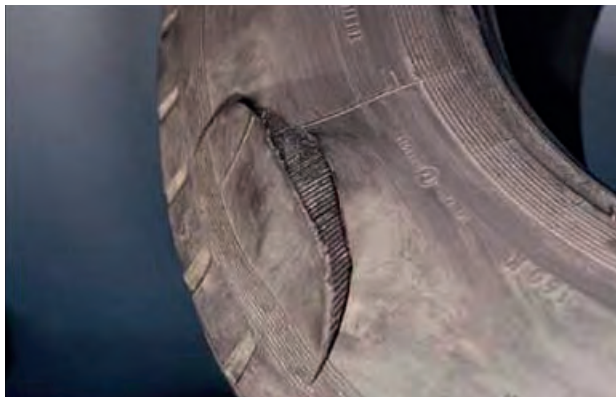
Paroi latérale éclatée en raison d'un percement du revêtement intérieur.
