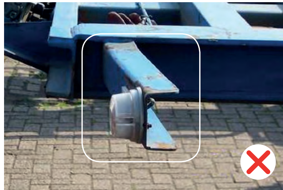
Support de feu tordu, pas de répercussion sur le client si la différence ne dépasse pas 10 % de l'angle à 90°. Répercussion sur le client en cas de dépassement de ladite limite et également si les inspections réglementaires exigent la réparation (MOT, etc.).
