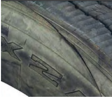
Pneu percé en profondeur au niveau du bord de la bande de roulement et paroi latérale endommagée.
