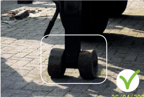
Dommmage aux roues et à l'axe de la béquille, sans conséquences néfastes sur l'utilisation.
