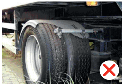
Aile endommagée et bavette manquante après éclatement du pneu.
