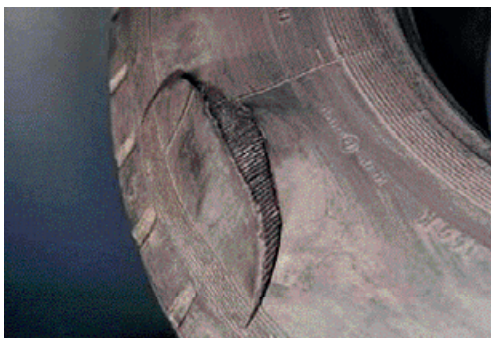
Paroi latérale éclatée en raison d'un percement du revêtement intérieur.
