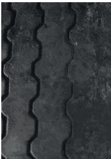
Usure irrégulière due à un mauvais alignement ou un bombement.
