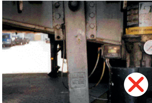
Béquille tordue, pas de répercussion sur le client si la différence ne dépasse pas 10 % de l'angle à 90°. Répercussion sur le client en cas de dépassement de ladite limite ou si la déformation affecte la fonctionnalité.
