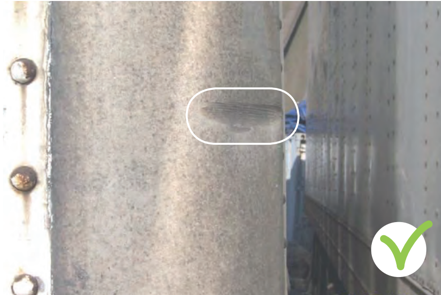
Poteau d'angle endommagé suite à une collision ; cabossé mais pas percé.
