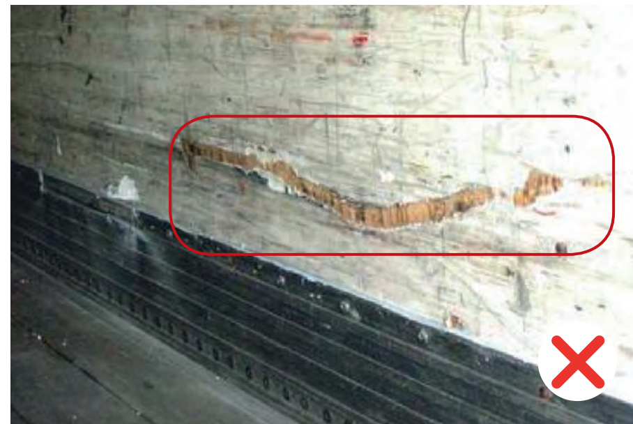
Perforation du panneau en stratifié de fibres de verre et arrachage du Gelcoat, mauvaise réparation des lisses de protection.
