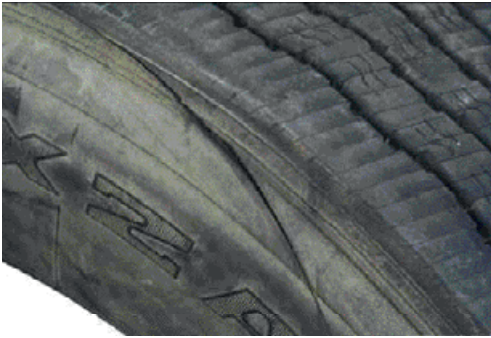
Pneu percé en profondeur au niveau du bord de la bande de roulement et paroi latérale endommagée.
