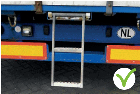
Echelle d'accès arrière restituée en bon état de fonctionnement.
