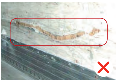
Perforation du panneau en stratifié de fibres de verre et arrachage du Gelcoat, mauvaise réparation des lisses de protection.
