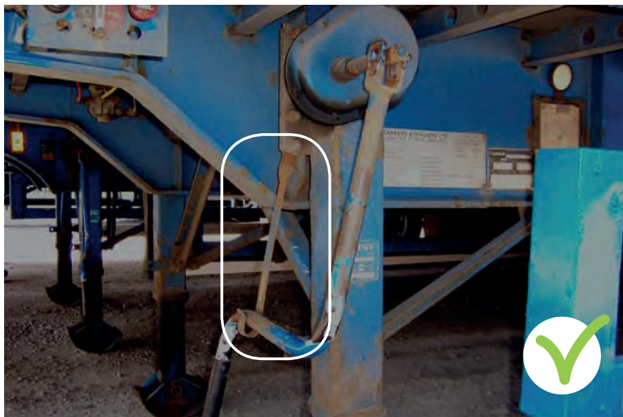
Béquille avec manivelle en position de sécurité.
