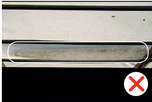
Raidisseurs de toit Edscha tordus en raison du poids d'une charge.
