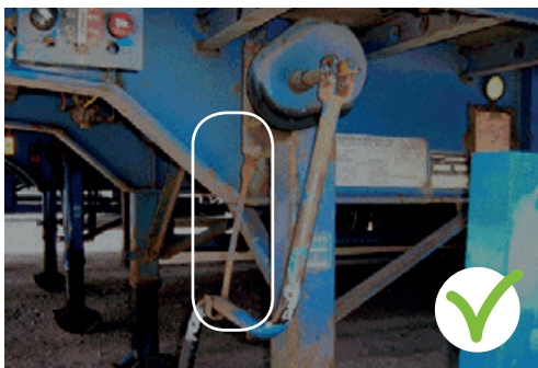
Béquille avec manivelle en position de sécurité.
