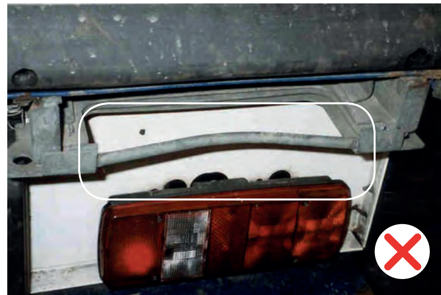
Echelle d'accès arrière restituée en mauvais état.
