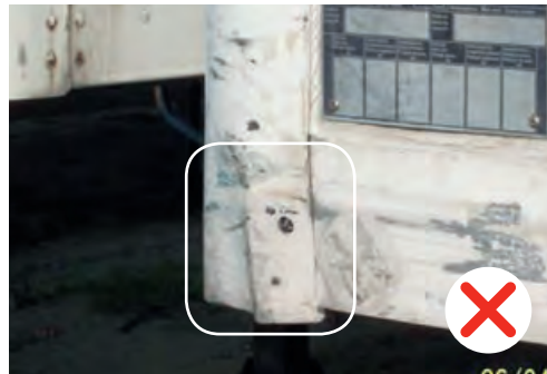
Poteau d'angle endommagé suite à une collision. Le feu de position avant est manquant.
