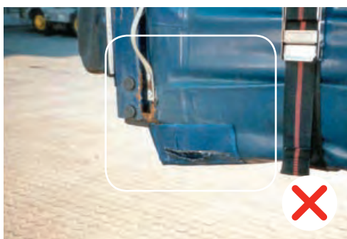
Entailles non-réparées dans le rideau sur le bord inférieur.
