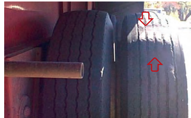
Pneus jumelés de diamètres différents ou dépareillés.
