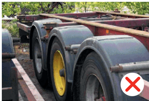
Roue de mauvaise couleur et ailes raccordées ; dommages éventuellement dus à une surcharge ou à une utilisation à une mauvaise hauteur de suspension.
