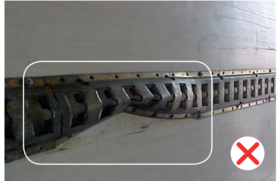
Détérioration irréparable du dispositif d'arrimage de la charge.
