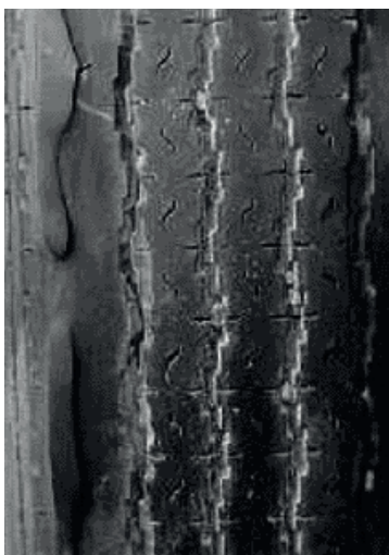
Usure irrégulière due à un défaut des suspensions.
