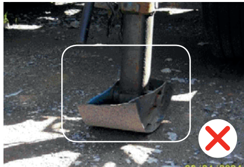
Les dommmages au patin compensateur de la béquille seront néfastes à l'utilisation et dépassent les limites de l'acceptable.
