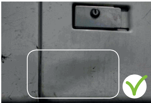
Portes légèrement cabossée sans con-séquences négatives sur l'esthétique de l'unité et ne gênant pas la manipulation des portes.
