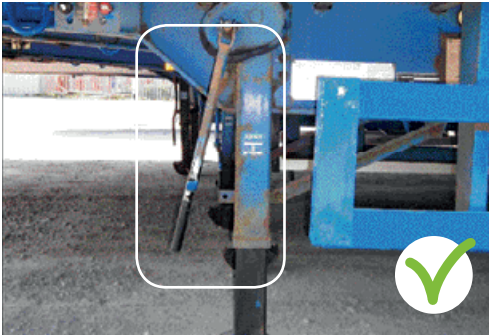
Béquille droite avec manivelle fixée.
