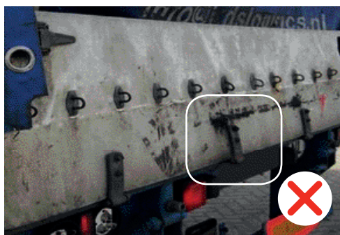
Portillon arrière tordu mais non percé ; la déformation gêne la manipulation du portillon.
