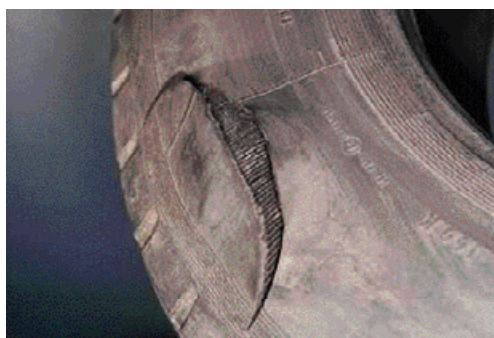
Scoppio della superficie laterale dovuto a penetrazione nel rivestimento interno.
