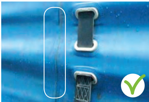
Corretta riparazione del pannello interno con i bordi del taglio ravvicinati e allineati.
