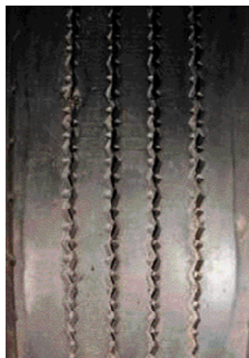
Rapida usura della spalla dovuta a gonfiaggio insufficiente.
