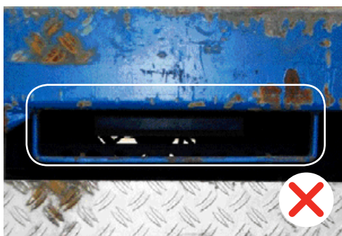
Mancata restituzione della scala per l'accesso sul retro.
