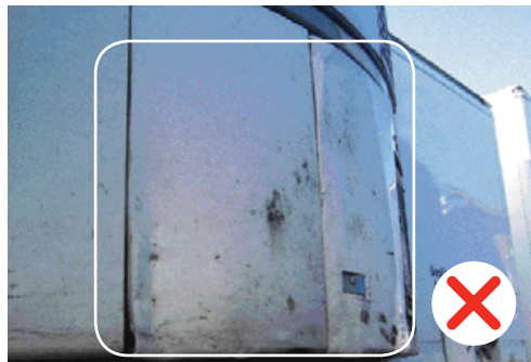
Danni gravi alle porte che impediscono il loro funzionamento.
