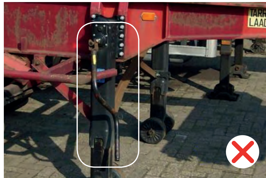
Puntello sostituito, ma nessuna posizione di sicurezza della maniglia. Nel caso in cui siano montate zampe Jost la verniciatura invalida la garanzia.
