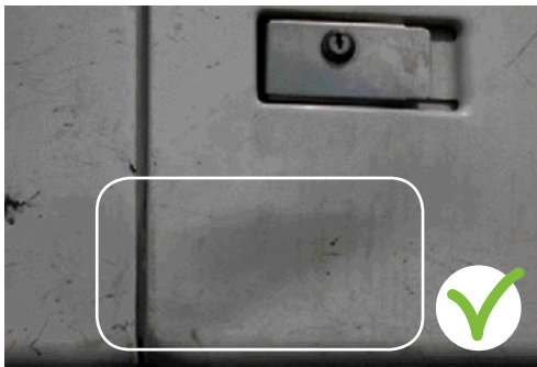
Ammaccature superficiali alle porte che non influenzano negativamente l'aspetto estetico del mezzo e non impediscono il funzionamento delle porte.
