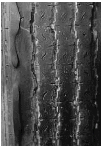
Usura irregolare dovuta a problemi di sospensioni.
