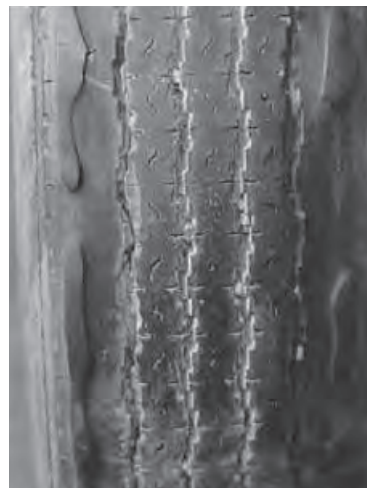
Usura irregolare dovuta a problemi di sospensioni.
