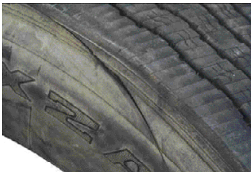
Danno di penetrazione profonda nel pneumatico, nella spalla e nella superficie laterale.
