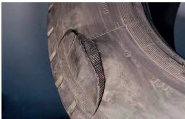
Scoppio della superficie laterale dovuto a penetrazione nel rivestimento interno.
