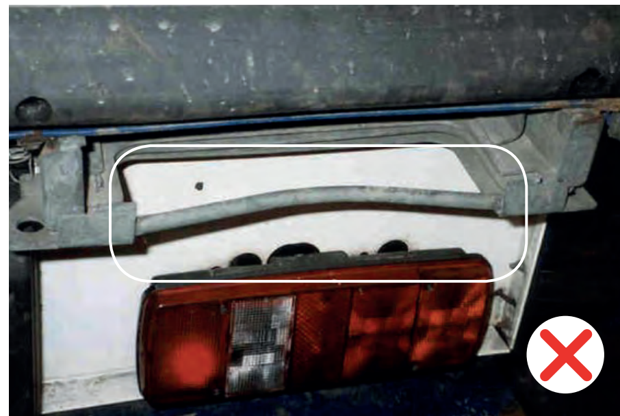
Scala per l'accesso sul retro restituita danneggiata.
