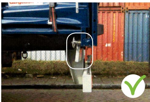
Braccio della lampada posteriore piegato.
