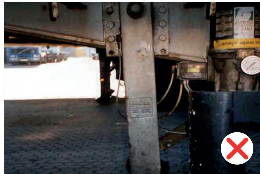
Puntello piegato, nessun addebito al cliente se la differenza non è superiore al 10% dell'angolo retto. Addebito al cliente se viene superato il limite indicato o se la funzionalità ne risente.
