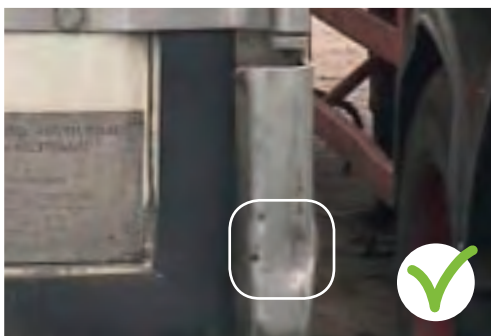
Piegatura del supporto delle cerniere della porta posteriore derivante da urti, che non compromette il funzionamento della porta.
