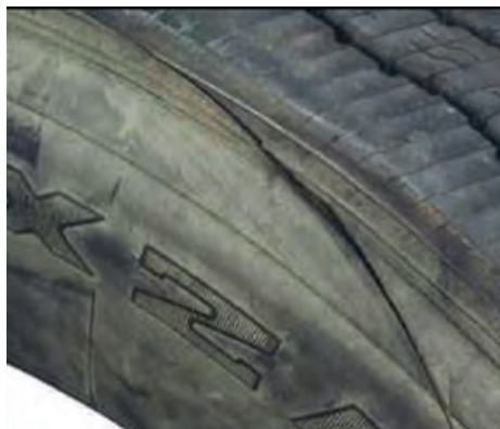
Danno di penetrazione profonda nel pneumatico, nella spalla e nella superficie laterale.
