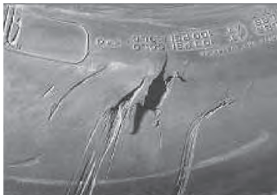
Danno di penetrazione profonda nella superficie laterale del pneumatico.
