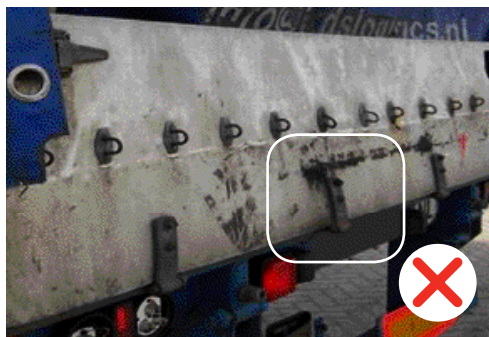
Pannello di accesso laterale piegato ma non forato, distorsione che non impedisce il funzionamento dell'accesso.
