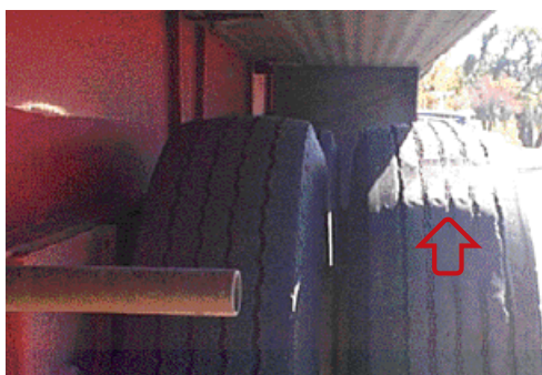
Diametro diverso dei pneumatici gemelli o accoppiamento non adatto.
