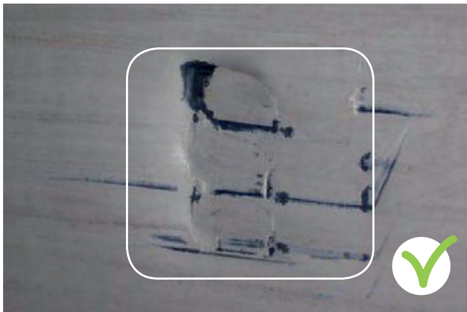
Pannello refrigerante in Ferroplast non penetrato.
