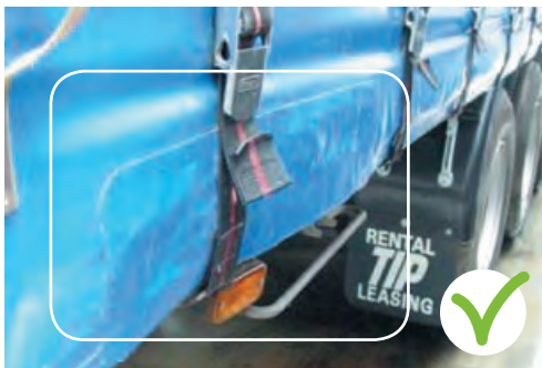
Buona riparazione del pannello esterno con angoli arrotondati per impedire il sollevamento.
