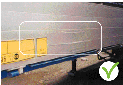
Pannello di accesso laterale danneggiato a causa di urti, non infiltrato e profilo non distorto.
