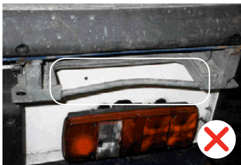
Scala per l'accesso sul retro restituita danneggiata.
