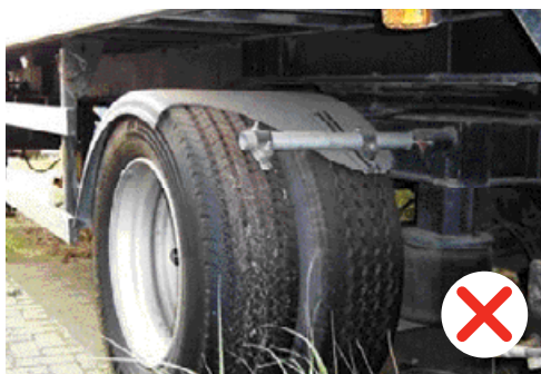
Parafanghi danneggiati e bavette mancanti a seguito dello scoppio di un pneumatico.
