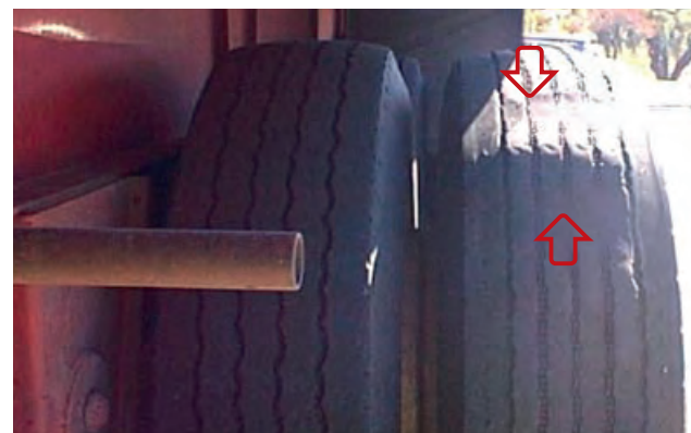
Diametro diverso dei pneumatici gemelli o accoppiamento non adatto.
