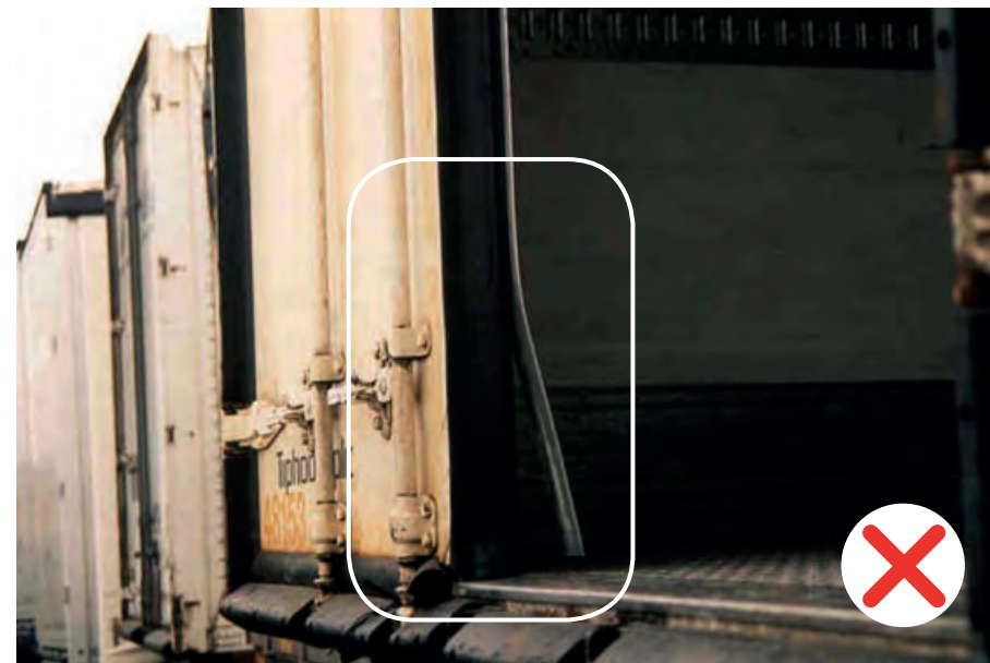
Danni alla rifinitura di alluminio della chiusura della porta.
