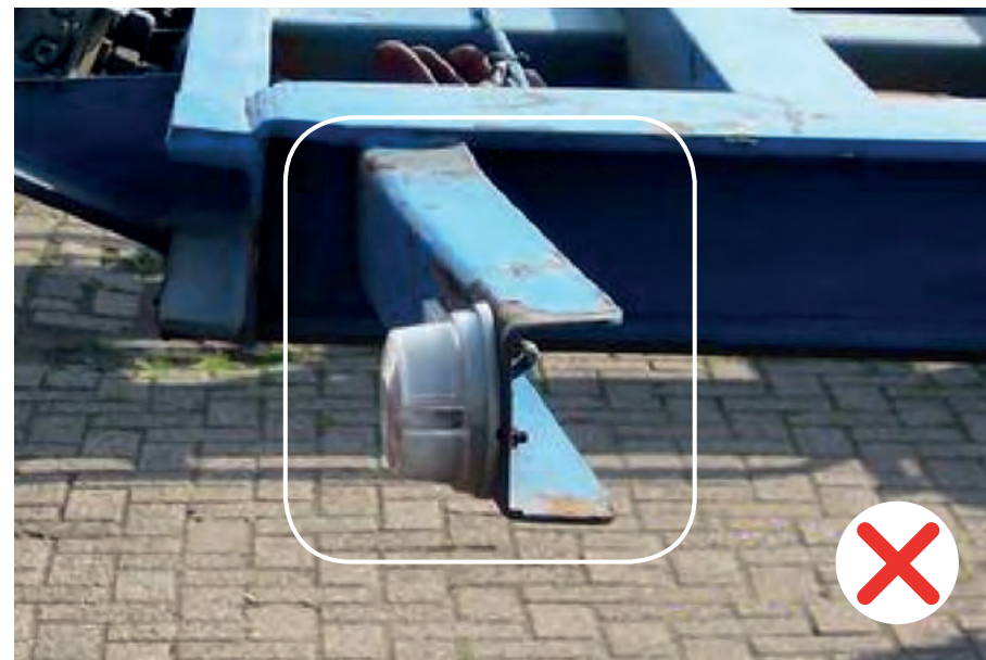
Braccio della lampada piegato, nessun addebito al cliente se la differenza non è superiore al 10% dell'angolo retto. Se il limite sopra indicato viene superato, addebito al cliente. Lo stesso avviene se la riparazione viene ordinata a seguito di ispezioni previste per legge (MOT, etc.)
