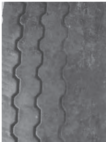
Usura irregolare dovuta al disallineamento o al profilo stradale.
