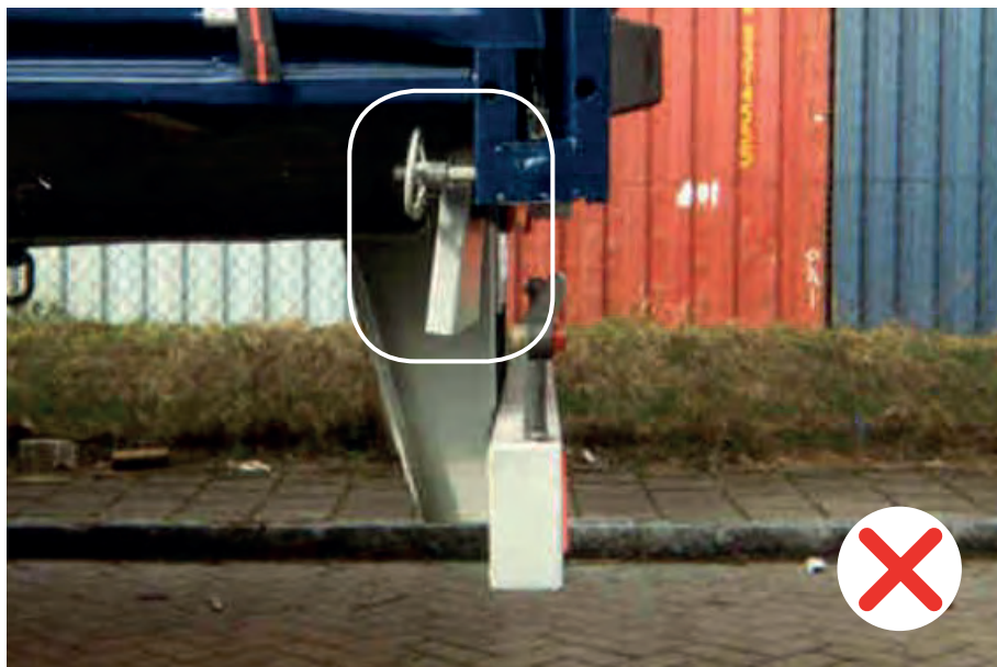
Braccio della lampada posteriore piegato.
