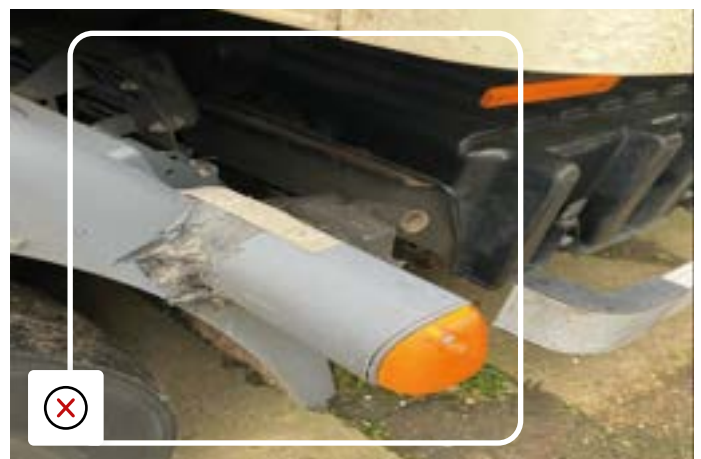
Substandard reparasjon av sideforsterkerens montering
