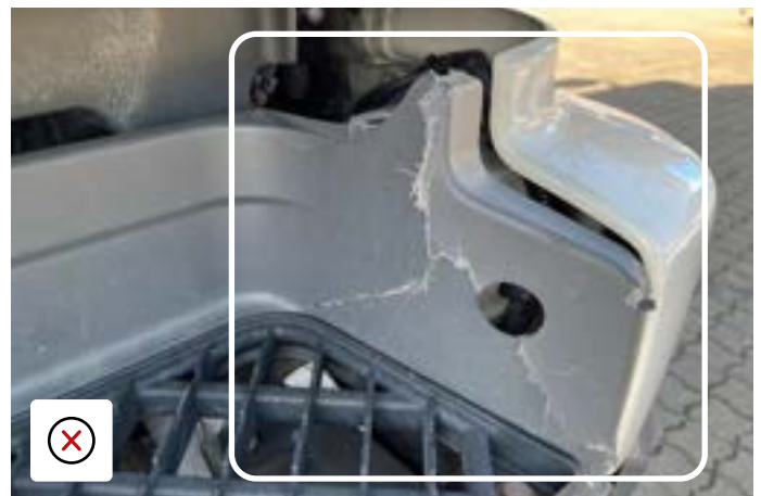
Trinnets støttestruktur er utrygg på grunn av støt.
