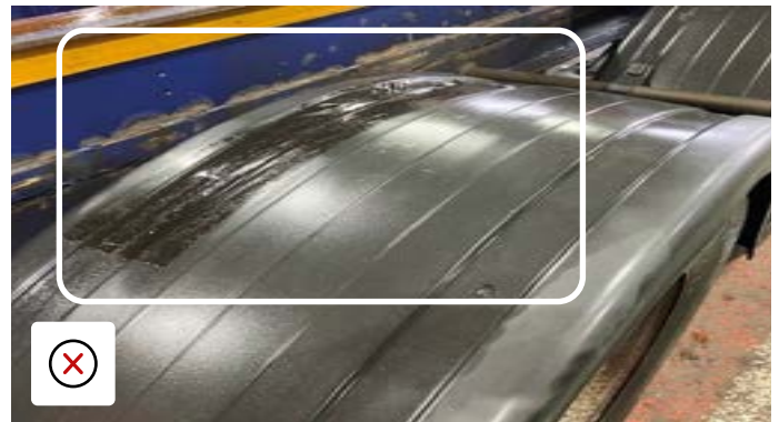
Lappet vinge krever utskifting
