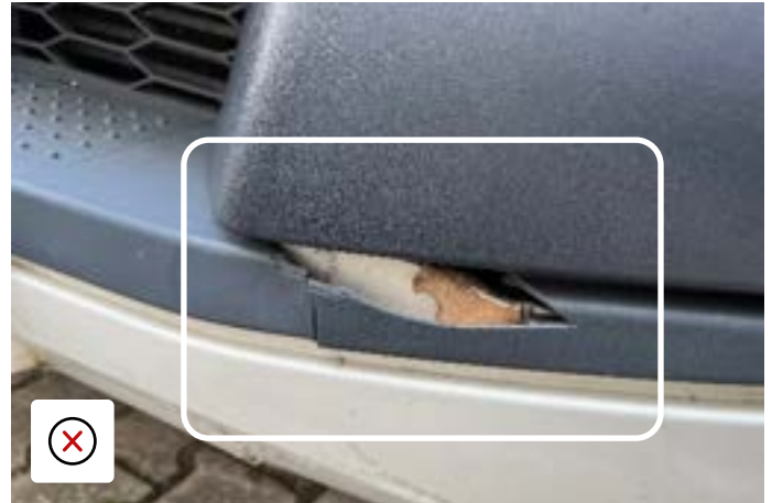
Større støtfangerkollisjon - støtfangeren er ikke egnet for formålet
