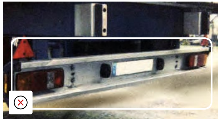
Underkjøringsbeskyttelsen er bøyd og må repareres
