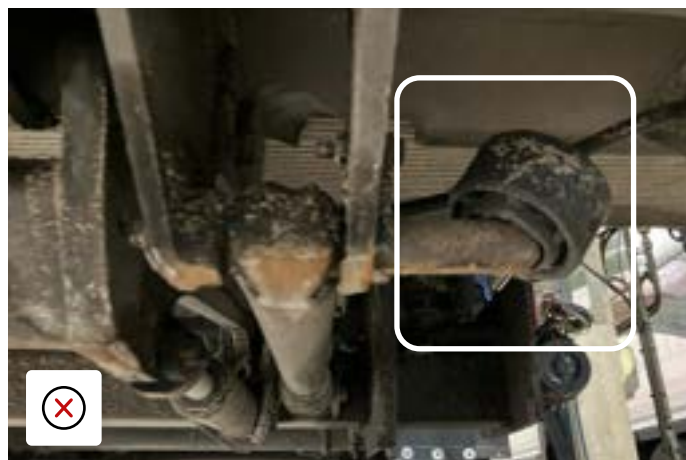
Rulle ødelagt på grunn av støt - må skiftes ut
