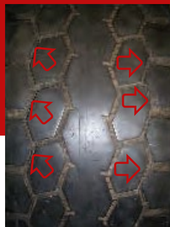
Sprekker i slitebanesporet på grunn av for høy lufttrykk
