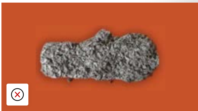
TPMS-sensor forurensset av tetningsmasse
