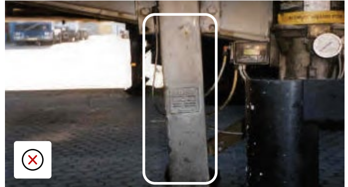
Landingsbenet er bøyd og må skiftes ut
