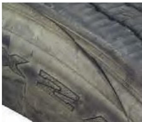
Dyp penetrasjon i dekk, skulder- og sideveggskeer.
