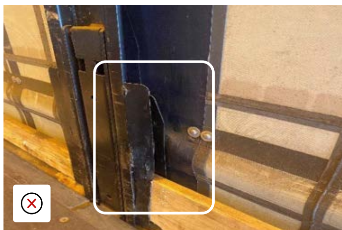
Kortholderbrakett bøyd av støt
