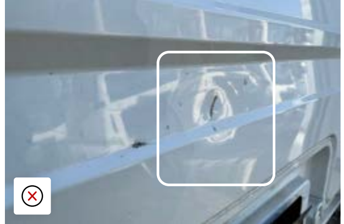
Kollisjonsskade på baksiden av førerhuset som har forårsaket sprekker
