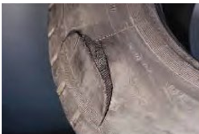
Sideveggutblåsning på grunn av penetrering av indre linje.
