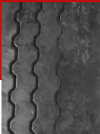
Ujevn slitasje på grunn av feil innretting eller krumming
