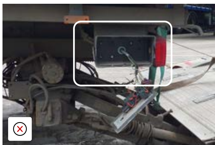
Ekstern bryter ødelagt - må skiftes ut
