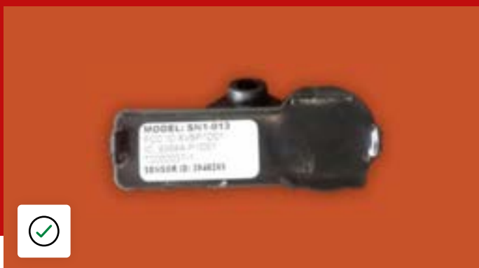
TPMS-sensor i akseptabel tilstand
