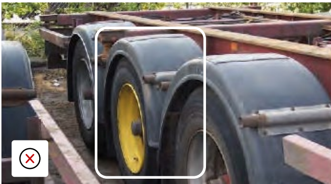
Feil farge på hjul og lappede vinger, skade muligens på grunn av overbelastning eller kjøring i feil kjørehøyde.
