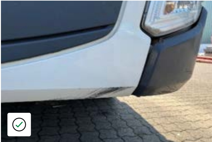
Mindre skrape - ingen skade på strukturen
